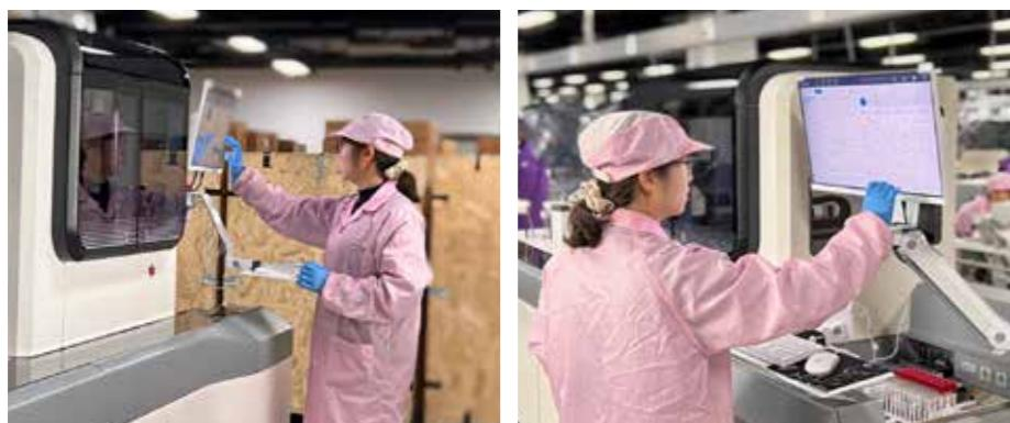
上午八时，我司二楼生产大厅里异常忙碌，Metis 6000项目组成员们紧张地围绕在流水线旁边，做发货前最后的调试和检查。Metis 6000全自动生化免疫流水线，集成MAGICL 6200免疫模块及CM-1000生化模块，搭载全新的SH80样本处理系统和SH200离心开盖模块，实现样本从进样、离心、开盖至检测的全流程自动化，助力医疗质量与运营效率提升。Metis 6000具有高效、智能、轻便、灵活的特点：免疫模块的测速400 T/h，首样本检测时间12 min；离心开盖模块，样本管的处理速度都是320
